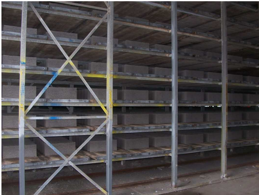
Etuvage à froid de blocs béton.
