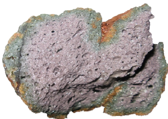
Coupe d'un granulat d'ardoise expansée
