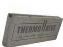
La planelle **THERMO'RIVE®**  $R = 0.85 \text{ M}^2.\text{K}/\text{W}$  assure en une seule opération, le traitement des ponts thermiques linéiques longitudinaux et transversaux, et assure le coffrage de l'about de dalle du plancher.
