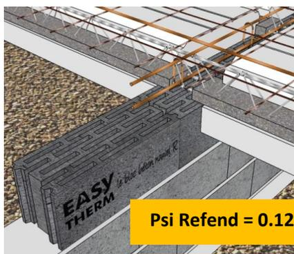
Le bloc **EASYTHERM®**  $R = 1.44 \text{ M}^2.\text{K}/\text{W}$  (Bloc+Rsi+Rse) permet de réduire de **70%** les pertes linéiques du Refend Central lorsqu'il est mis en œuvre uniquement en dernier rang.
